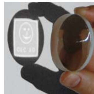
Freiformflächen sind ein Markenzeichen der OEC AG. Aus der definierten Fläche und Form der sogenannten Smiley-Linse wird Licht so gelenkt, dass ein scharfes Bild entsteht.
