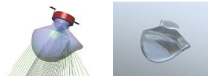
Die Bilder zeigen eine 3D-maßgeschneiderte Linse zur gleichmäßigen Ausleuchtung einer Treppenstufe – einmal als Simulation mit Strahlengang, einmal die fertige Linse.
